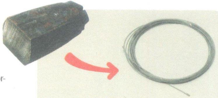
Para convertir el bloque de hierro en alambre hay que utilizar una máquina especial, que hace pasar el hierro por un agujero, y del otro lado tira del alambre que se forma.
